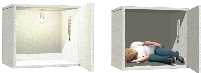
Figur 3. Forsøgsopstilling med henholdsvis elpære og person i flamingo-kasse. Kassen skal lukkes tæt.
